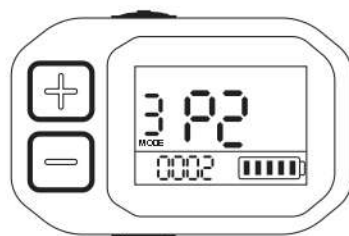
P2: Einstellung des Bildschirm-Timeouts zwischen 0 und 30 Minuten; 0 bedeutet, dass er nie schläft.
