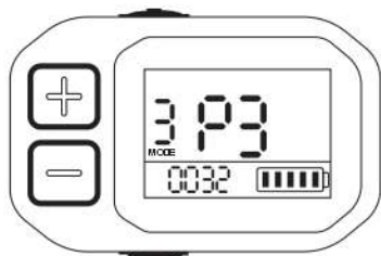
P3: impostazione del limite di velocità tra 0-25km/h; il limite di velocità predefinito è 25km/h.
