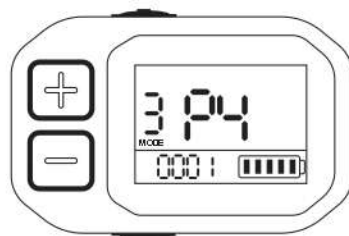
P4: Einstellung der Standard-Geschwindigkeitsstufe; 0 bedeutet Start mit Geschwindigkeitsstufe 0 und 1 bedeutet Start mit Geschwindigkeitsstufe 1.
