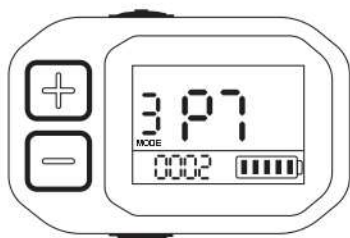
P3 : réglage de la limite de vitesse entre 0-25km/h ; La limite de vitesse par défaut est de 25km/h.
