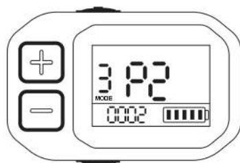
P2 : réglage du délai d'attente de l'écran entre 0 et 30 minutes ; 0 signifie qu'il ne dort jamais.
