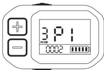
P1 : réglage de la luminosité du rétro-éclairage de l'écran du niveau 1 à 3 ;
