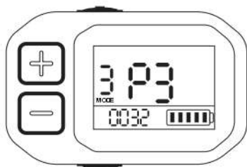
P3 : réglage de la limite de vitesse entre 0-25km/h ; La limite de vitesse par défaut est de 25km/h.
