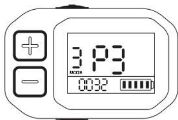
P3: Einstellung der Geschwindigkeitsbegrenzung zwischen 0 und 25 km/h; die Standardgeschwindigkeitsbegrenzung beträgt 25 km/h.
