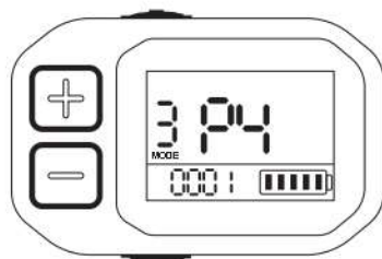
P4 : réglage du niveau de vitesse par défaut ; 0 signifie le démarrage au niveau de vitesse 0, et 1 signifie le démarrage au niveau de vitesse 1.
