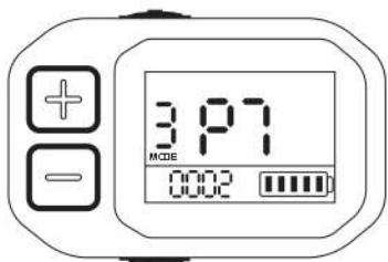
P7: attivazione/disattivazione della funzione di blocco della bicicletta; 0 significa che la funzione di blocco è disattivata e 1 significa che la funzione di blocco è attivata. L'impostazione predefinita è 0.
