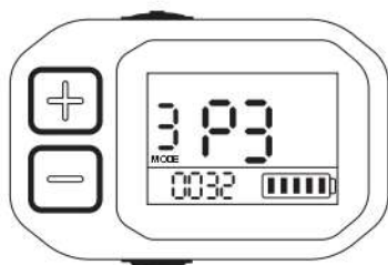
P3: ajuste del límite de velocidad entre 0-25km/h; El límite de velocidad por defecto es de 25km/h.
