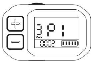
P1: Einstellung der Helligkeit der Hintergrundbeleuchtung des Displays von Stufe 1 bis 3;
