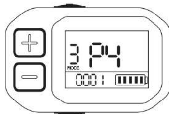
P4: impostazione predefinita del livello di velocità; 0 significa che si avvia al livello di velocità 0 e 1 significa che si avvia al livello di velocità 1.
