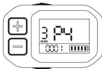
P4: ajuste del nivel de velocidad por defecto; 0 significa empezar en el nivel de velocidad 0, y 1 significa empezar en el nivel de velocidad 1.
