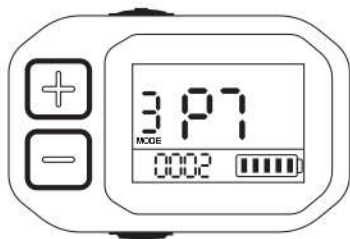
P3: ajuste del límite de velocidad entre 0-25km/h; El límite de velocidad por defecto es de 25km/h.
