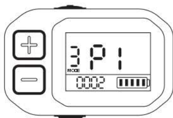
P1: ajuste del brillo de la retroiluminación de la pantalla del nivel 1 al 3;
