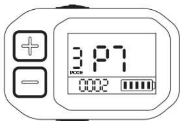
P3: Einstellung der Geschwindigkeitsbegrenzung zwischen 0 und 25 km/h; die Standardgeschwindigkeitsbegrenzung beträgt 25 km/h.
